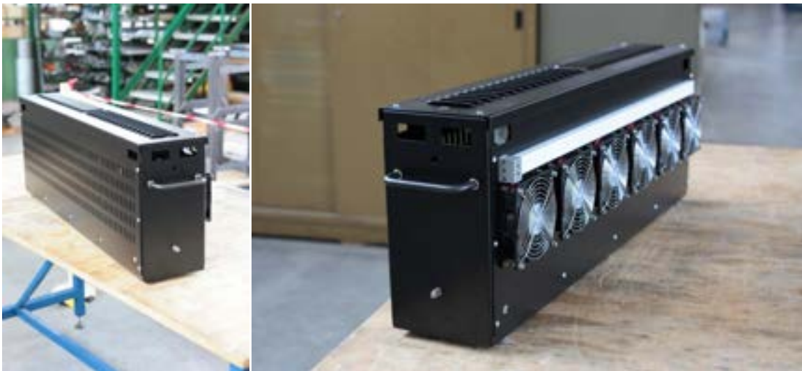
Fig. 10 Vista di insieme del case a) lato forato b) lato con i ventilatori
