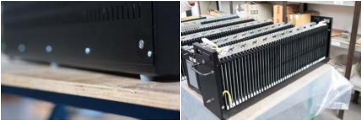
Fig. 7 Struttura di contenimento a) Base b) Vista laterale con le celle
