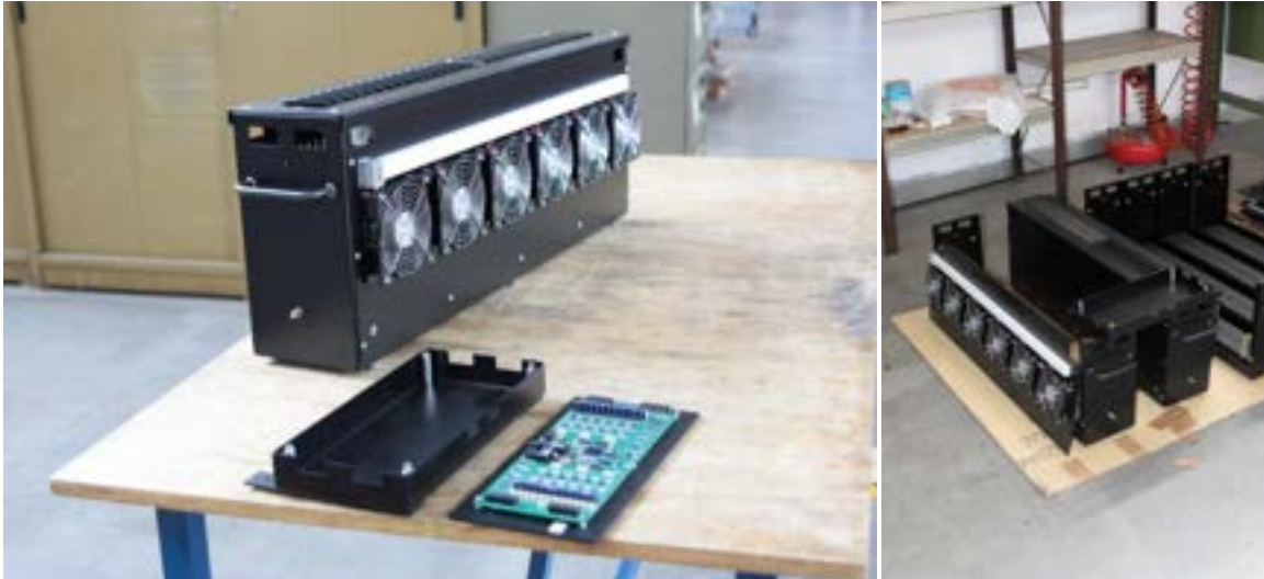
Fig. 11 a) Alloggiamento per il Mux b) schema di montaggio
