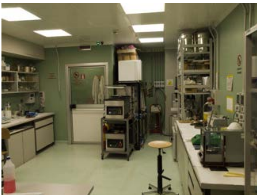
Figura 3. Foto del laboratorio ad umidità controllata (< 10 ppm) impiegato per la preparazione degli elettroliti misti.
