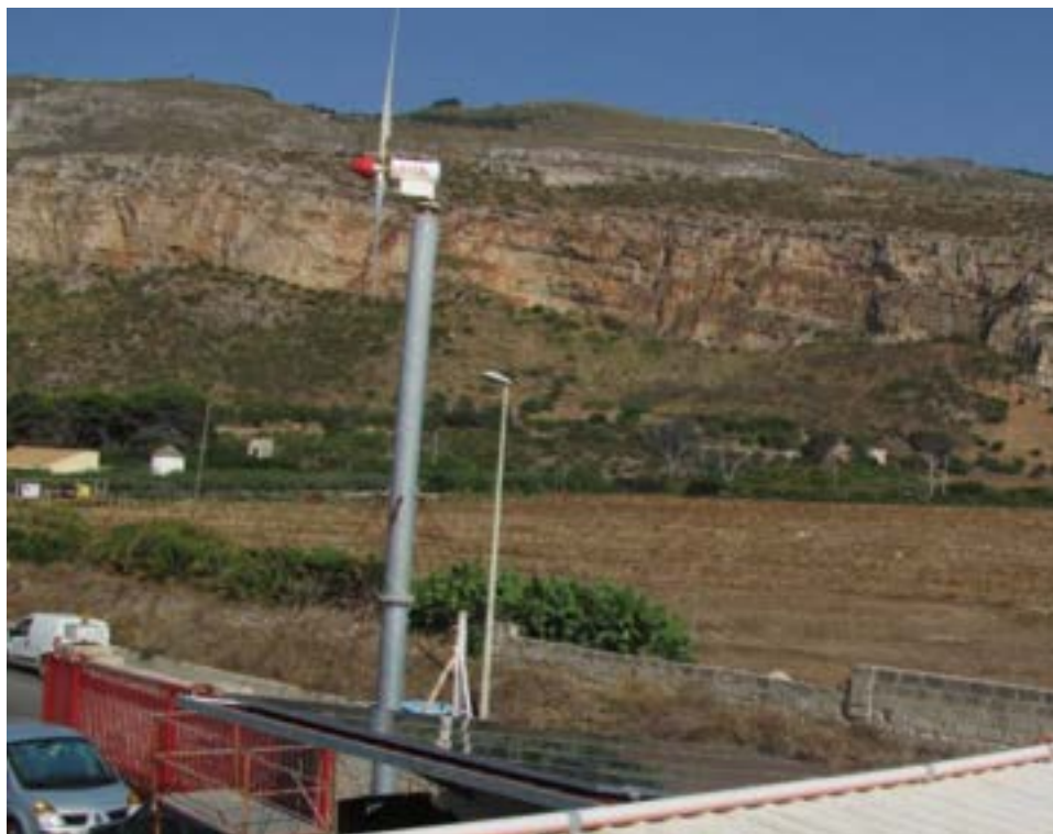
Fig. 4.10 - Campo FV in silicio amorfo utilizzato per la fase di test (campo 2).
