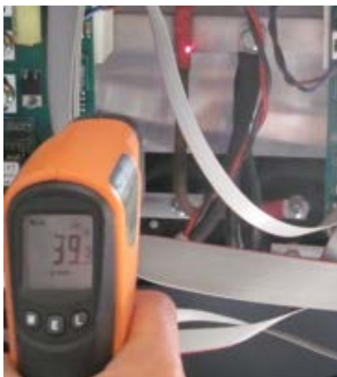
Fig. 4.25 – Schermata del termometro a infrarossi riportante il valore misurato della temperatura del dissipatore con dispositivo in modalità grid-connected.
