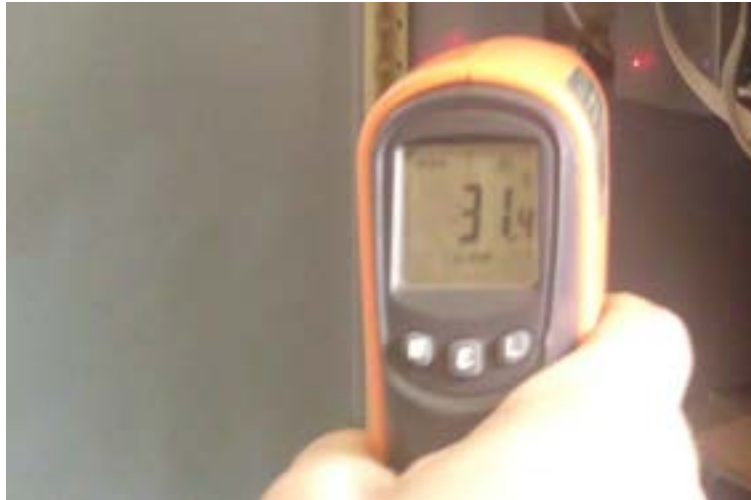
Fig. 4.27 – Schermata del termometro a infrarossi riportante il valore misurato della temperatura interna con dispositivo in modalità grid-connected.
