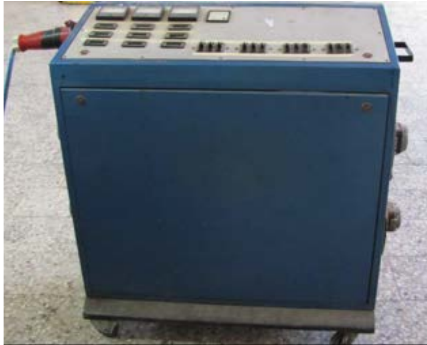
Fig. 4.11 - Banco di resistori trifase da 15 kW.
