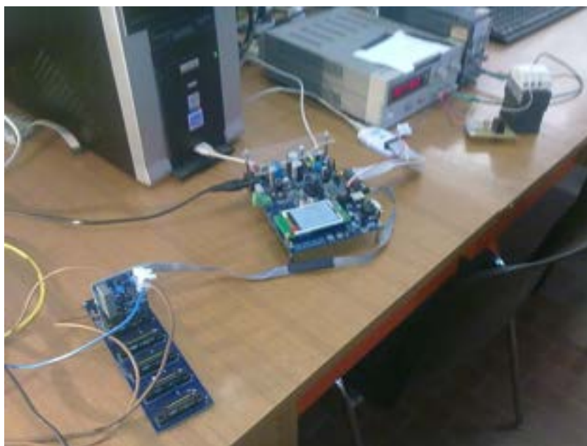
Fig. 4.14 – Sistema realizzato per la verifica, in laboratorio, del funzionamento del DDI realizzato.
