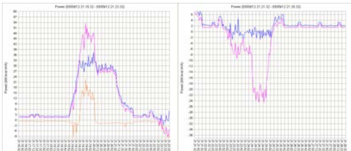
Figura 18. Corsa di salita e di discesa del 05/09/2012 ore 21:16 per una sola fase.
