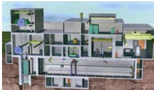
Figura 12: progetto preliminare dell'impianto di incapsulamento
