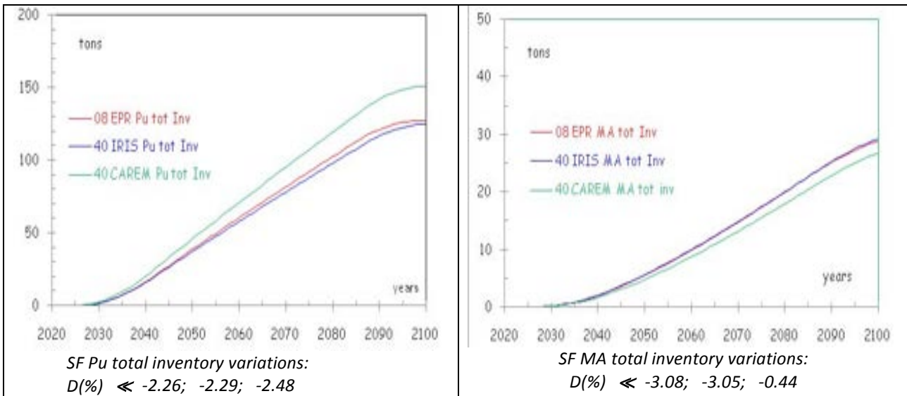
Figura 14: Effetto di diverse librerie di sezioni d'urto (Cesar4 vs Cesar5.1) nel codice COSI sugli inventari di plutonio e attinidi minori
