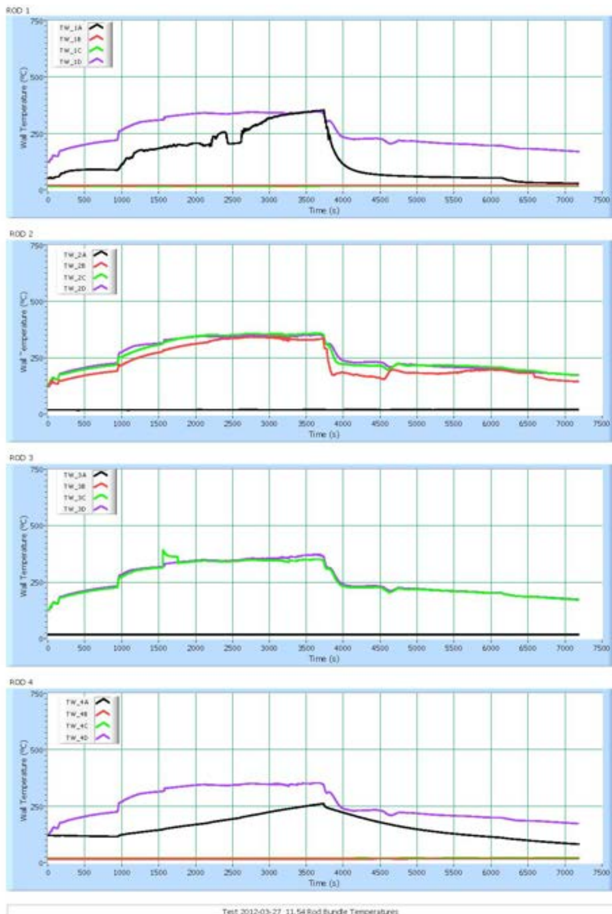
Figura 40 - Test 14 : Temperature di parete delle barre scaldanti
