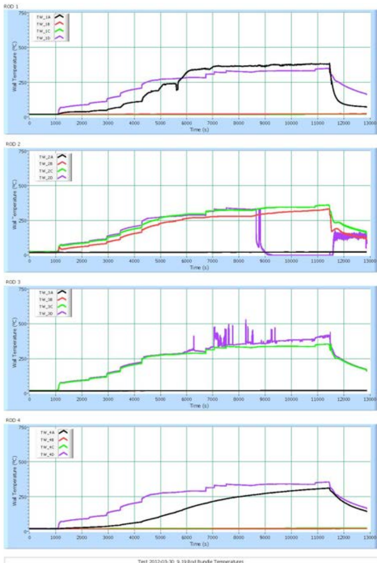
Figura 54 - Test 21 : Temperature di parete delle barre scaldanti
