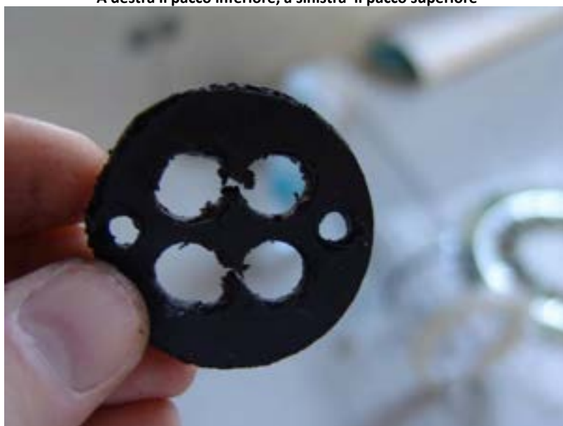
Figura 6 - Pacco di tenuta inferiore di Karlez® 7090
