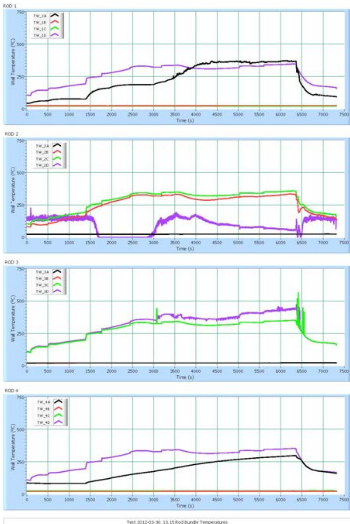
Figura 56 - Test 22 : Temperature di parete delle barre scaldanti
