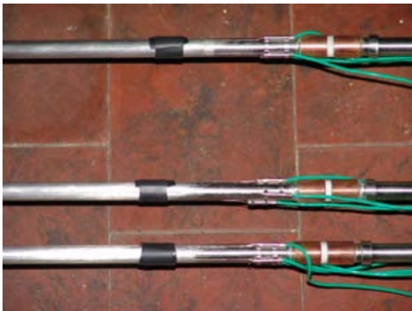
Figura 10 - Particolare delle termocoppie di parete delle barre
