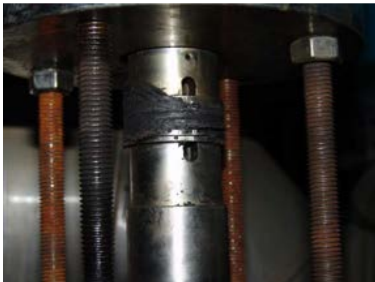
Figura 4 - Estrusione del pacco tenuta superiore delle barre Rotfil
