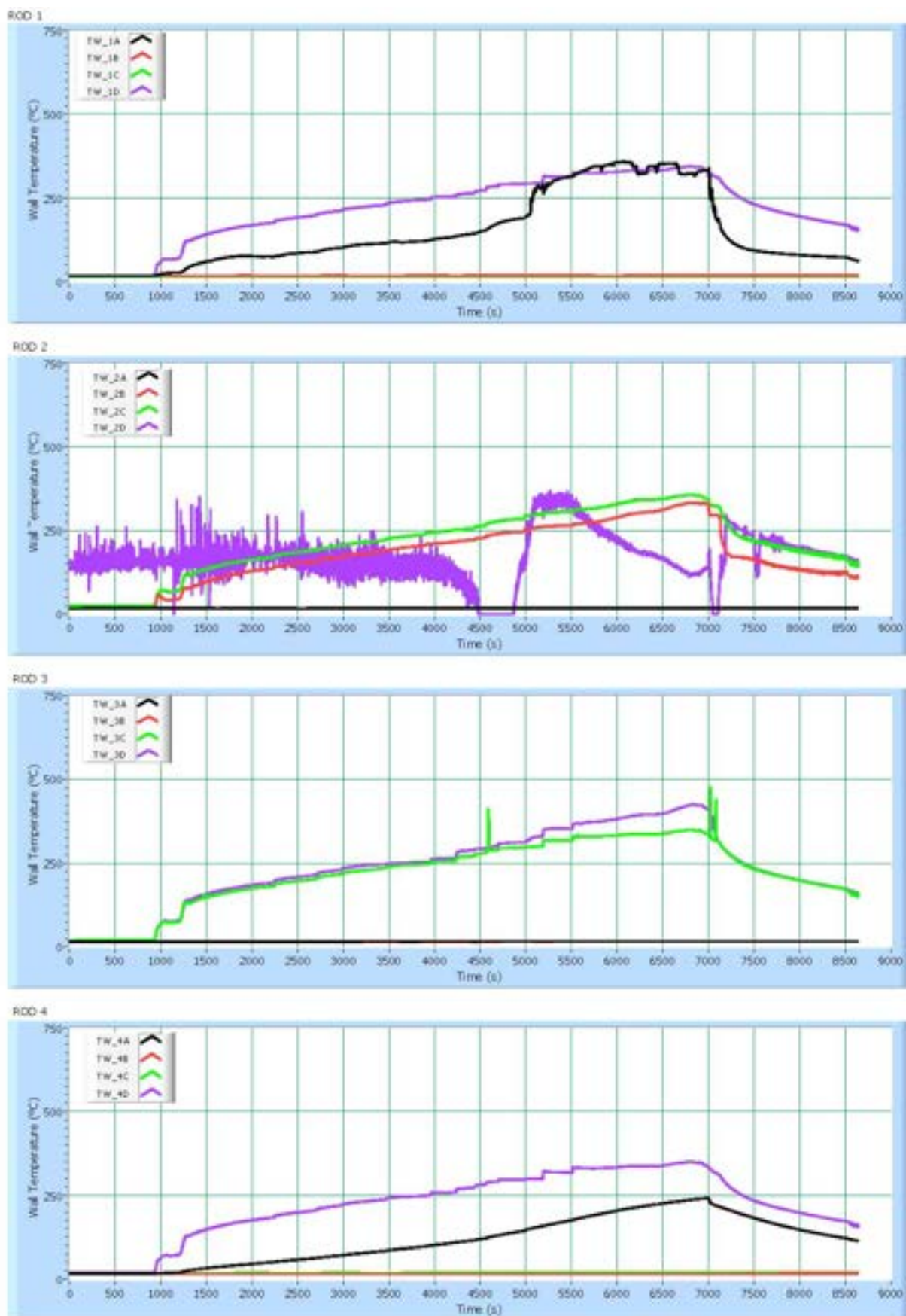
Figura 62 - Test 25 : Temperature di parete delle barre scaldanti
