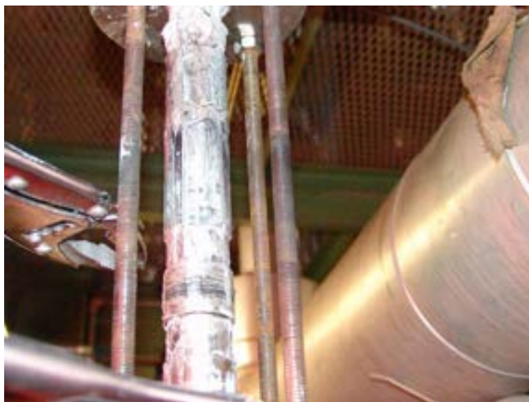
Figura 2 - Fascio di barre Rotfil appena estratto
