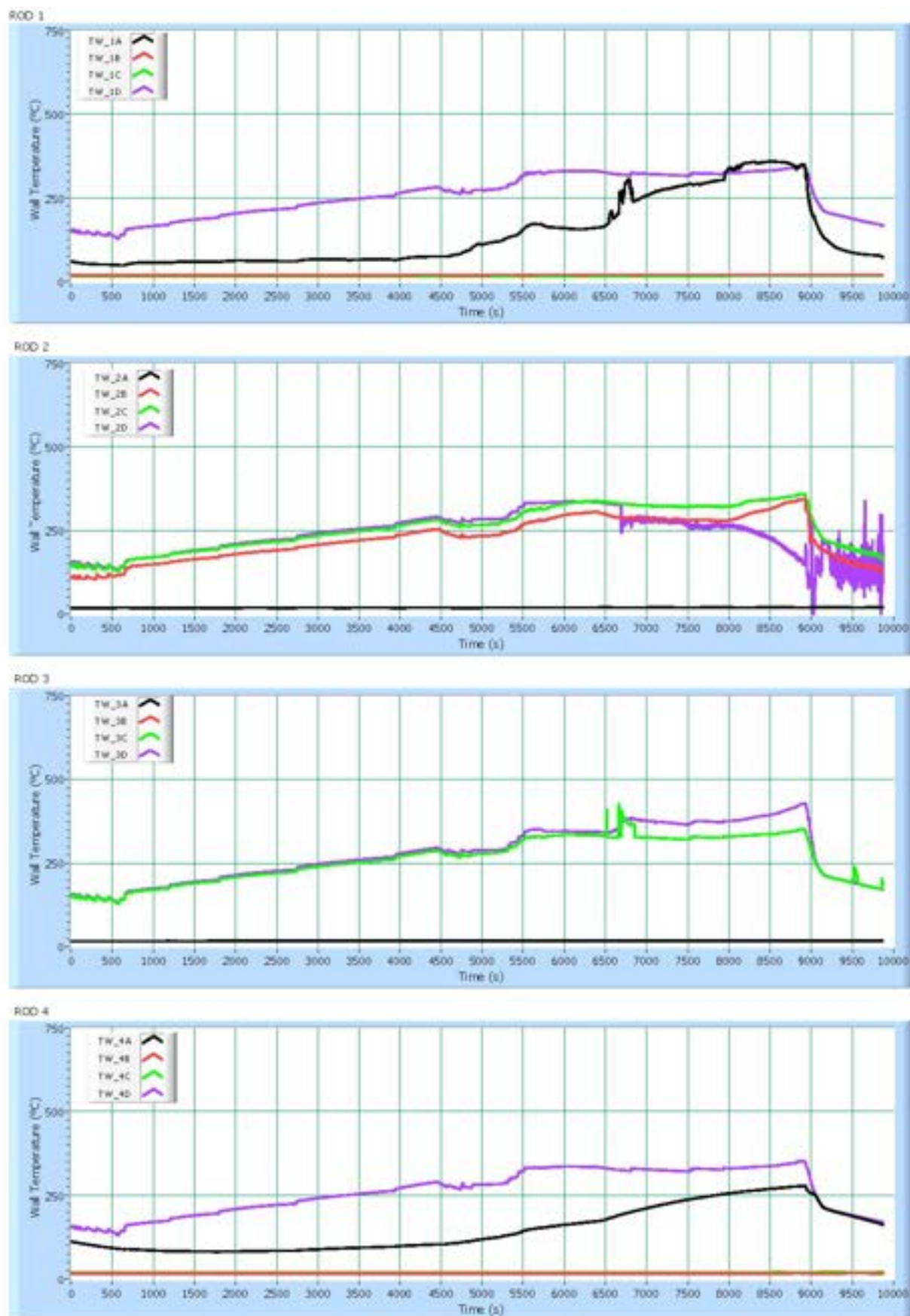
Figura 64 - Test 26 : Temperature di parete delle barre scaldanti
