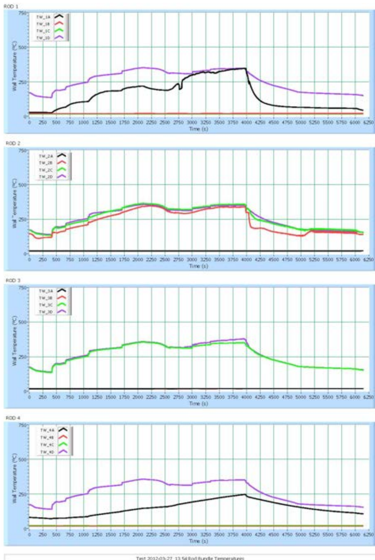
Figura 42 - Test 15 : Temperature di parete delle barre scaldanti
