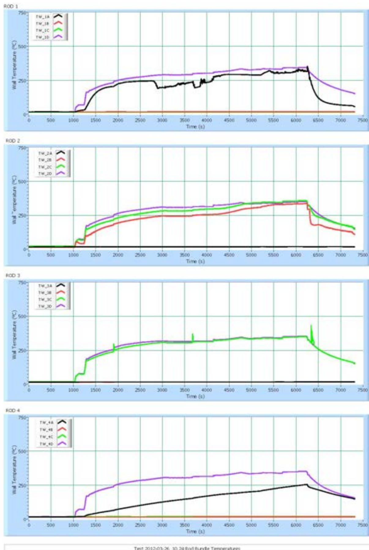
Figura 34 - Test 11 : Temperature di parete delle barre scaldanti
