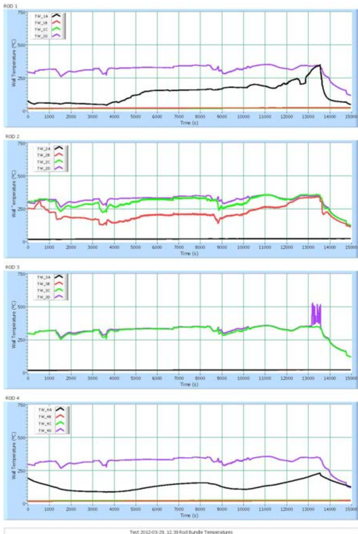
Figura 52 - Test 20 : Temperature di parete delle barre scaldanti
