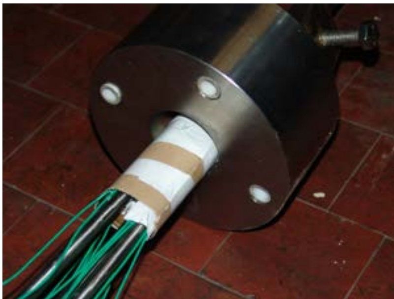
Figura 11 - Particolare della flangia di supporto e alimentazione delle barre
