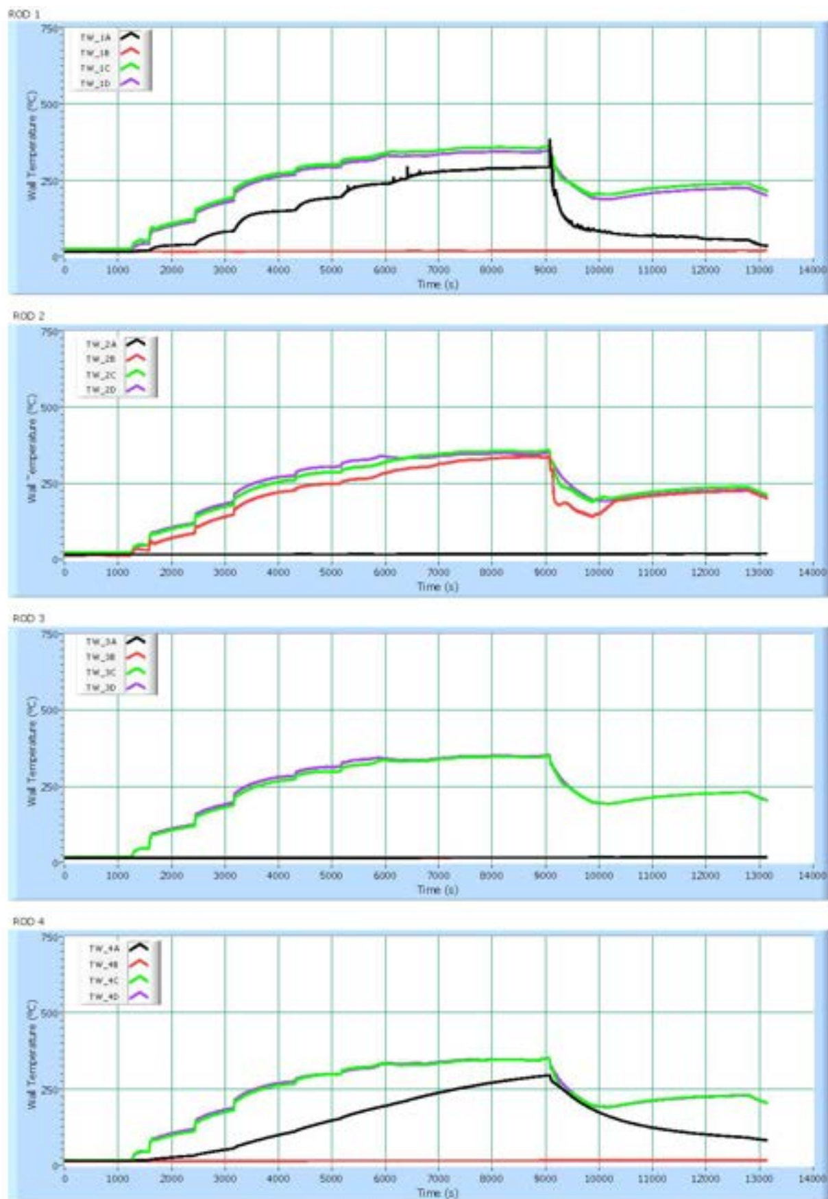
Figura 26 - Test 7 : Temperature di parete delle barre scaldanti
