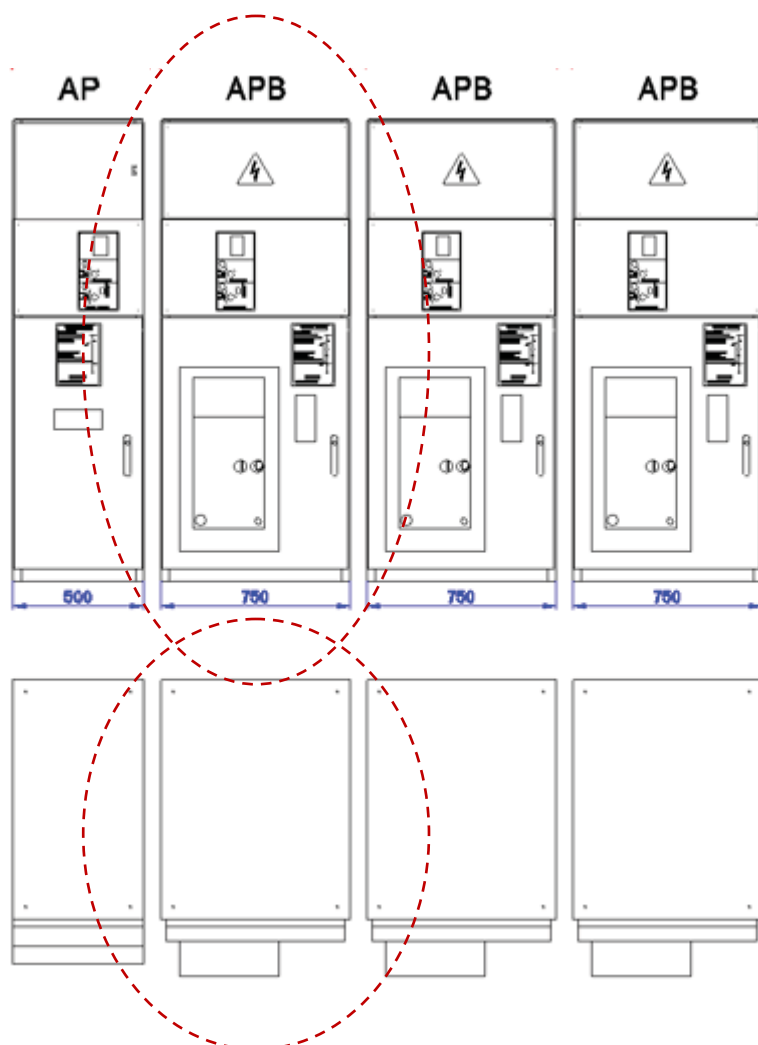
Fig. 7 Quadro elettrico: VISTA FRONTALE E DALL'ALTO (evidenziato l'interruttore oggetto del presente rapporto)
