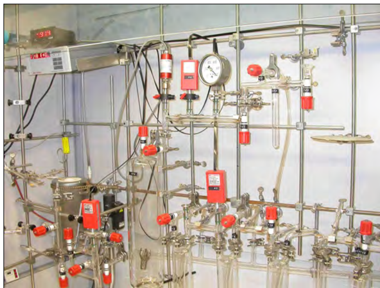
Figura 15 Linea di sintesi del benzene (processo finale) utilizzata nei laboratori ENEA
