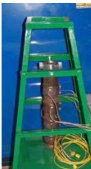
Figura 10: Riscaldatore per l'estrazione dei gas nobili dalla colonna dei carboni attivi.
