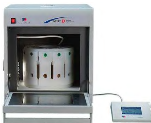
Figura 9 – Sistema di Mineralizzazione a Microonde Milestone Start-D
