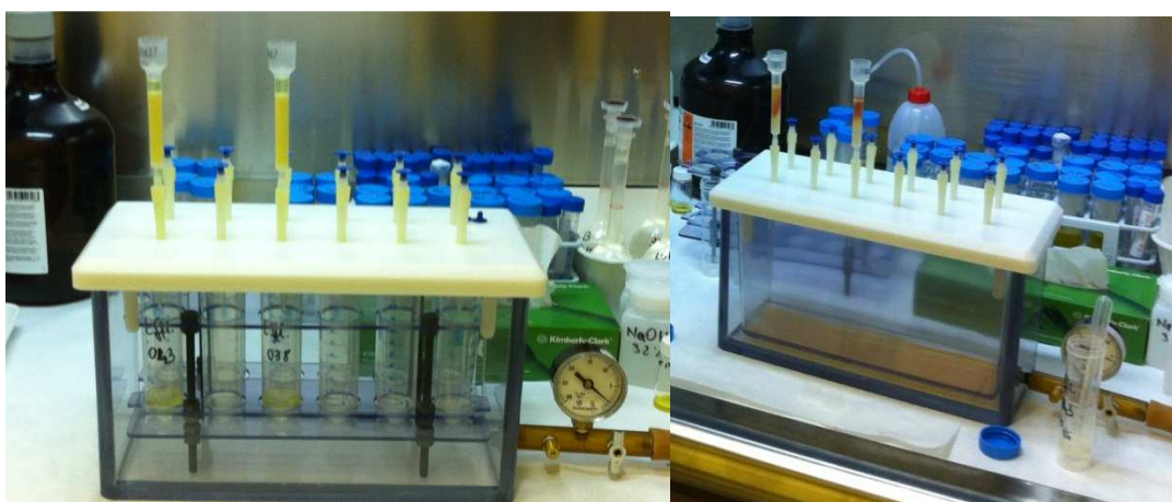
Figura 7 – Alcune fasi della separazione ^{55}\text{Fe} e ^{63}\text{Ni} su cartucce Eichrom™
