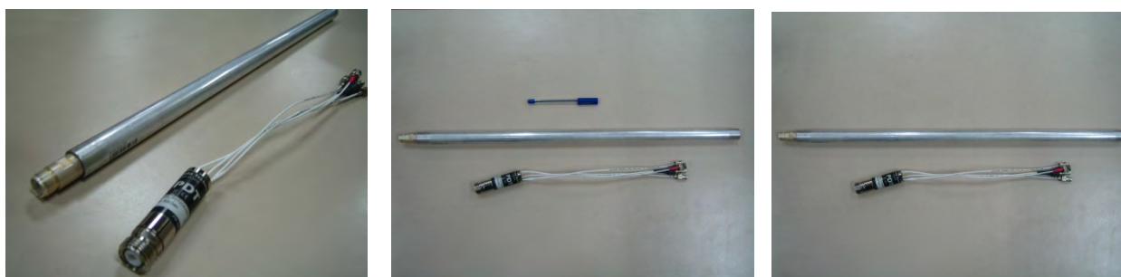
Figura 1 - Rivelatori Boron coated ed elettronica associata.
