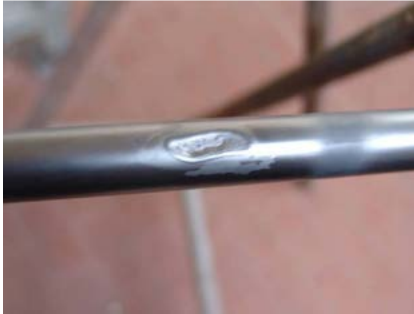
Fig.7. 1 – Dettaglio schiacciamento locale dell'elemento scaldante del pressurizzatore
