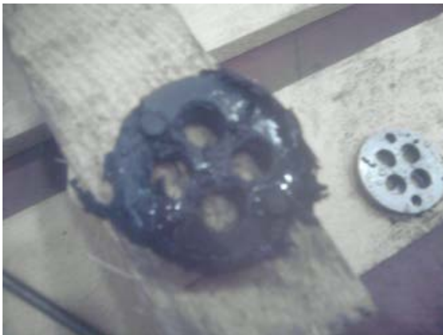
Fig. 4.9 - Effetti dell'inserzione ed estrazione del Kalrez dal sistema di tenuta
