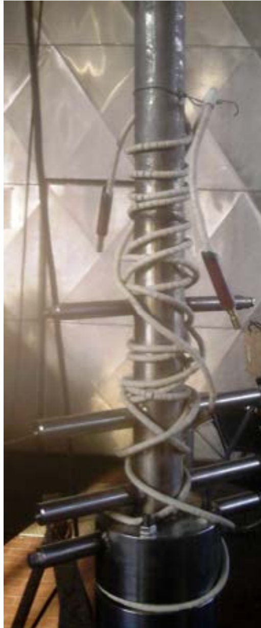
Fig. 4.3 - Riscaldamento elettrico esterno della tenuta
