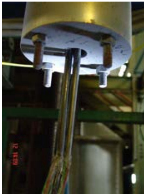
Fig.7. 2 – Terminazioni elettriche delle barre con guaine danneggiate
