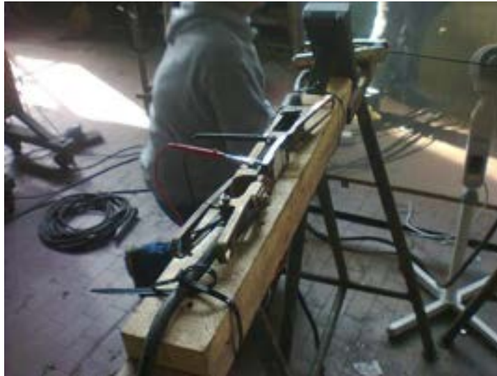
Fig.7. 4 –Allestimento per prove sulle guaine: collegamento morsetti
