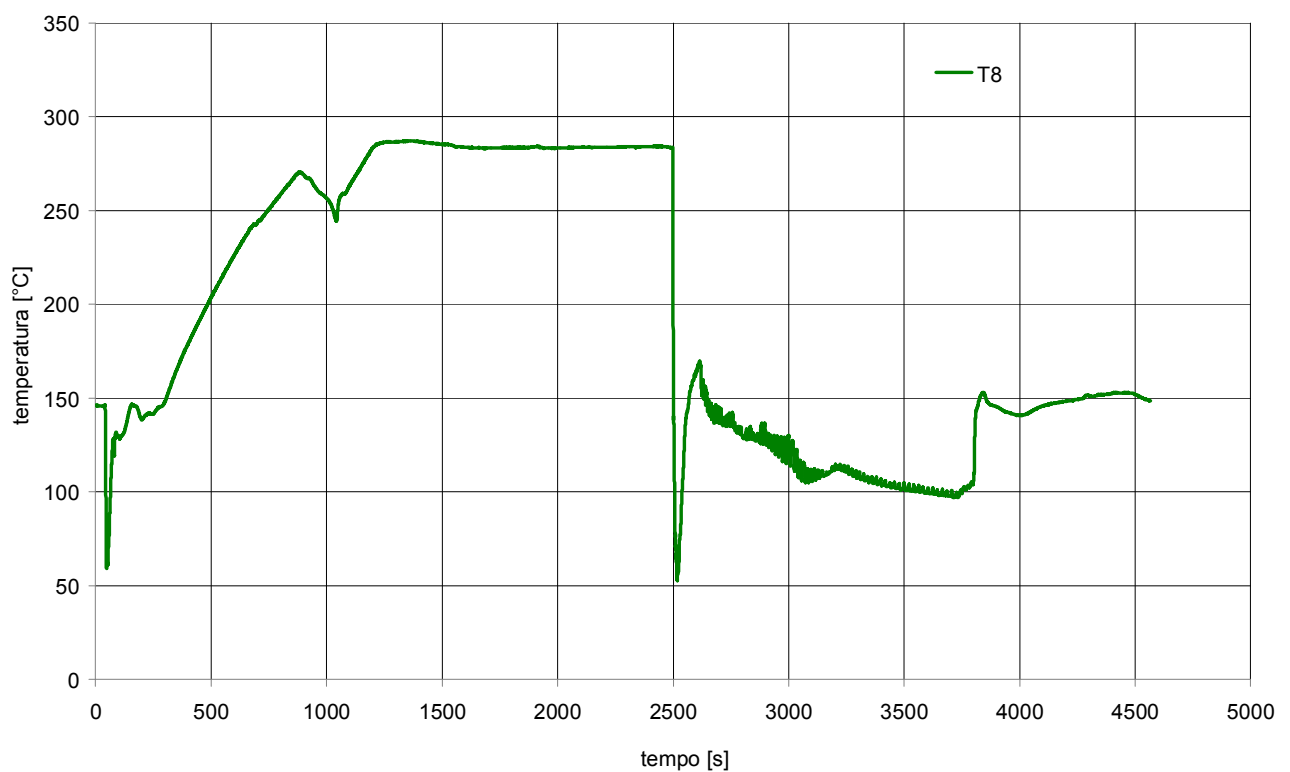
Fig. 8. 170 - Andamento della temperatura “circuito primario iniezione linea di ritorno” per il Test n°27
