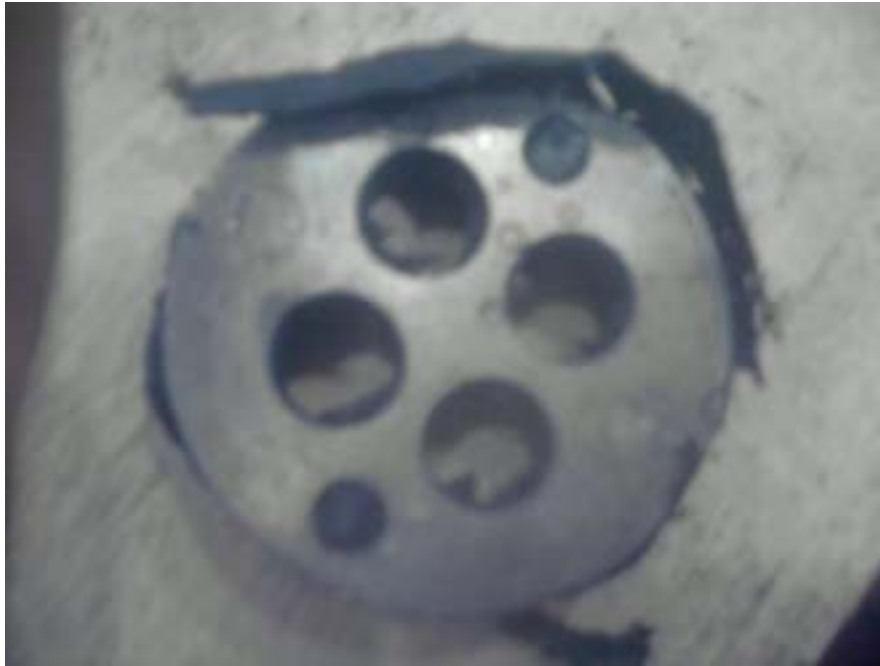
Fig. 4.8 - Estrusione del Kalrez negli spazi lasciati liberi dalle parti metalliche
