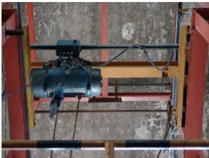
Fig. 4 - Carro ponte per la movimentazione delle sezioni di prova
