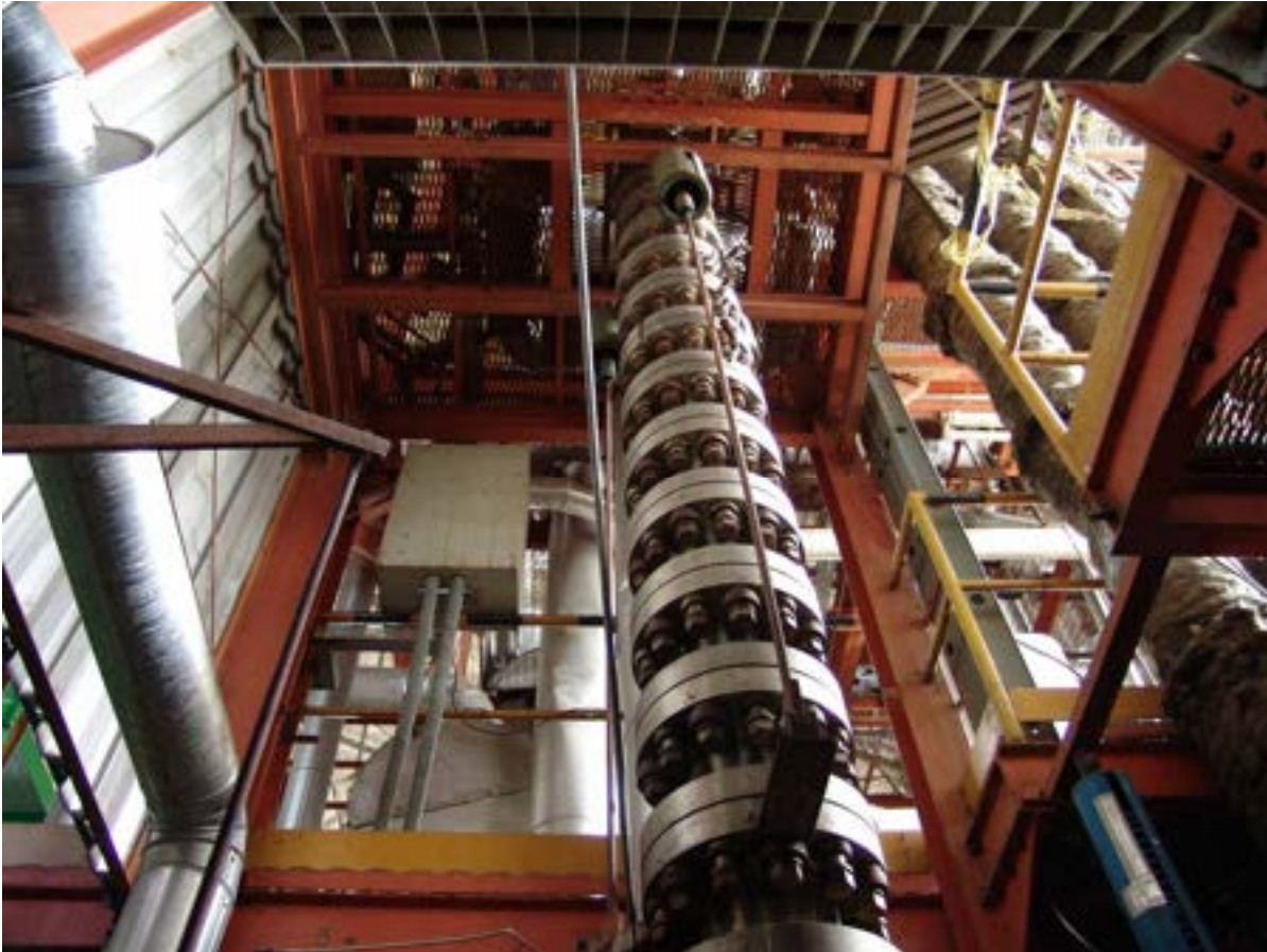
Fig. 1 - Zona sezioni di prova (con sezione da rimuovere)
