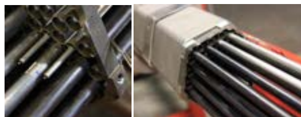
Particolare del fuel pin bundle installato nell'impianto CIRCE in configurazione ICE
