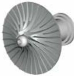
Fig. 3 – Cuscinetti magnetici e girante con diffusore del TurboCircolatore K300.
