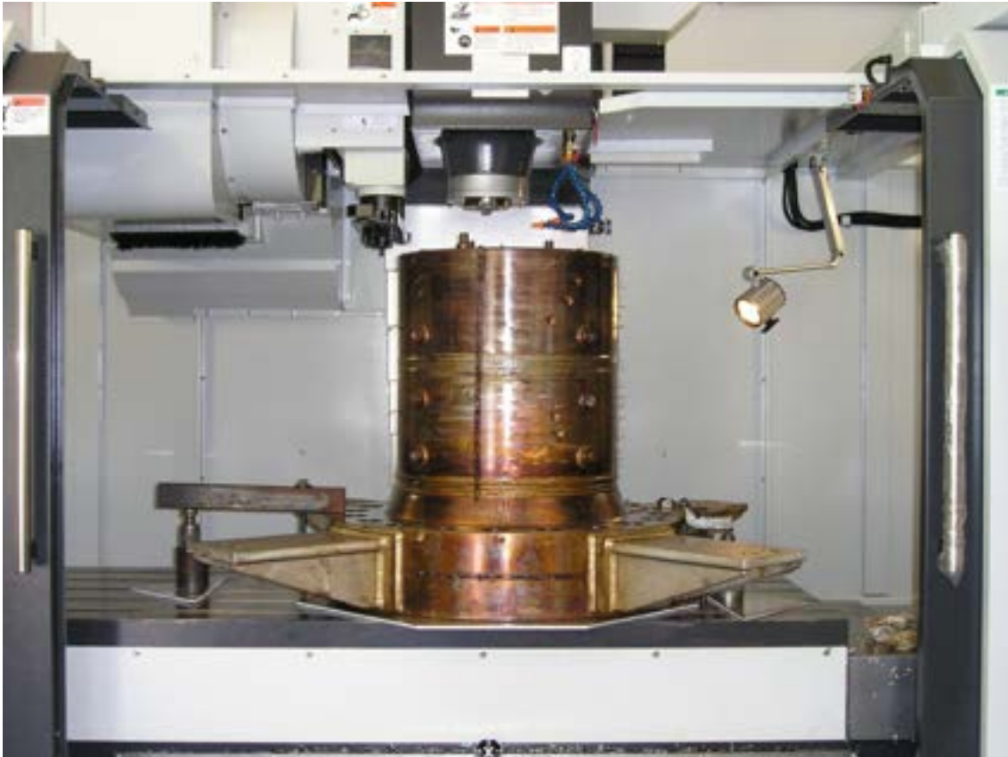
Figura 4.4. Lavorazione del vessel S1 per montaggio bocchello e flangia inferiore della nuova linea di iniezione acqua.
