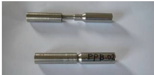
Fig. 34 – Provino PPB – 2 prima e dopo “imbutitura”
