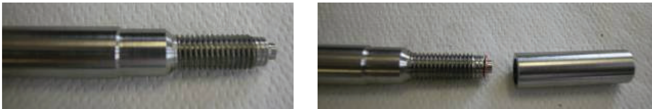
Fig. 39 – Particolare della filettatura del provino barretta (a sinistra), con la guarnizione calzata e provino griglia prima dell'assemblaggio
