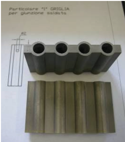
Fig. 22 - Griglie per saldatura (stringhe da 4 fori, dis. J 50 0119)
