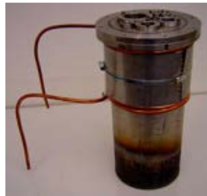
Serpentina di raffreddamento in rame
