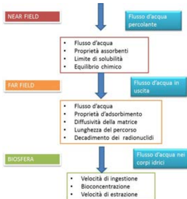
Figura 10 – Possibile schema delle interazioni semplificate usate per un modello di performance assessment (da confrontare con lo schema di fig. 9)
