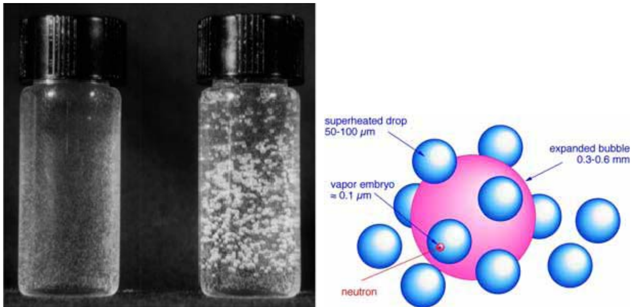
Figura 6 - Meccanismo di formazione della bolla
