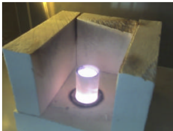
Figura 52 - Esempio di fusione in crogiolo in Allumina mediante forno a microonde realizzato presso il laboratorio del Brasimone
