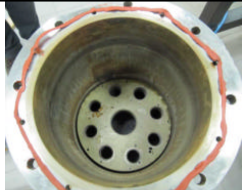
Interno vessel con il crogiolo inserito
