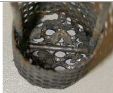
Interno del cestello anodico
