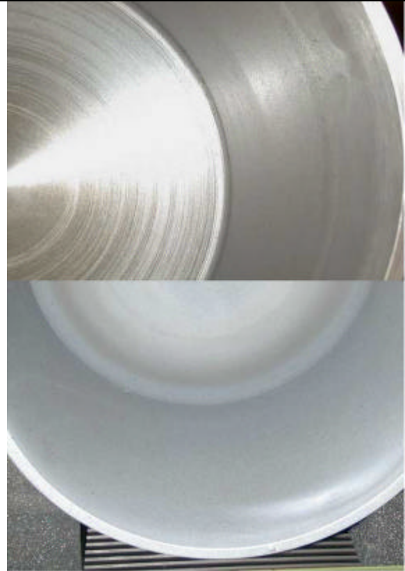
Crogiolo prima e dopo il rivestimento (dettaglio dell'interno)
