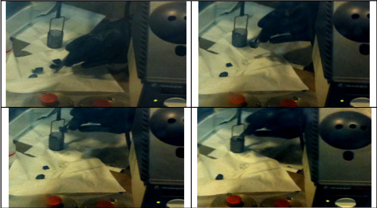
Figura 23 – Sequenza di caricamento lingotti di Lantanio nel cestello anodico
