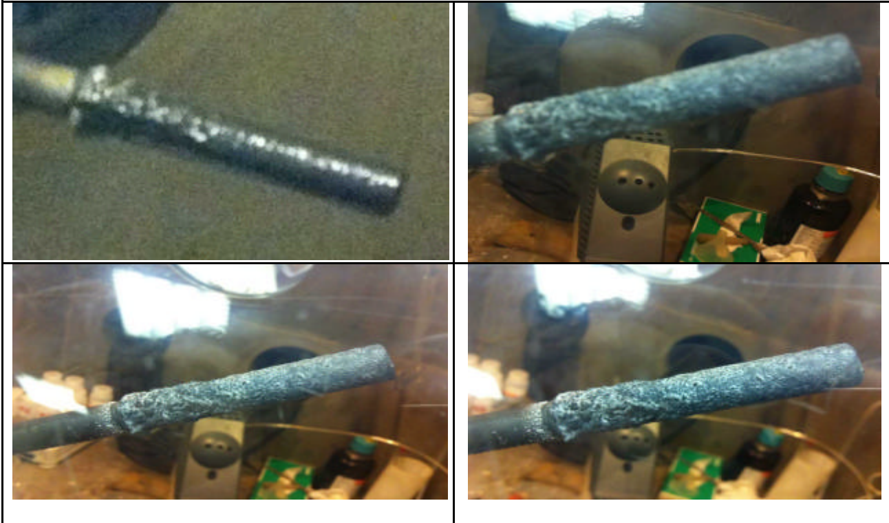
Figura 27 – Sequenza di estrazione del catodo dal bagno elettrolitico
