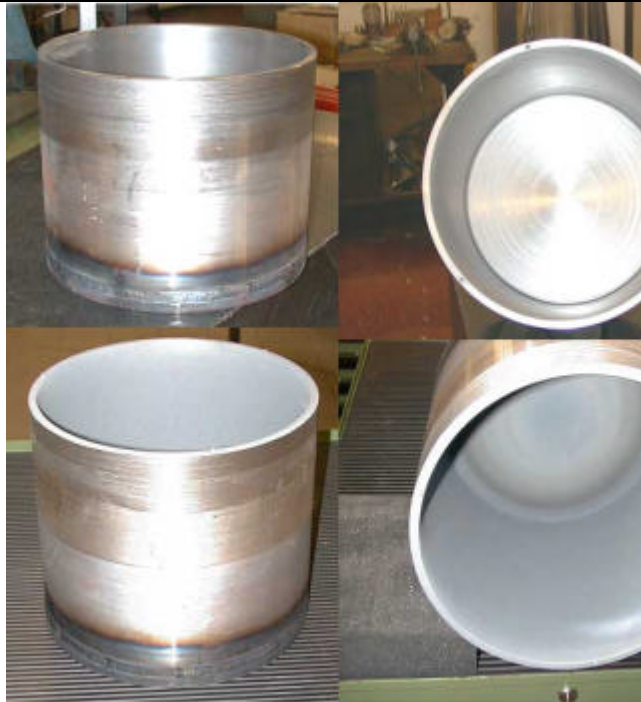
Crogiolo prima e dopo il rivestimento (veduta laterale e centrale)
