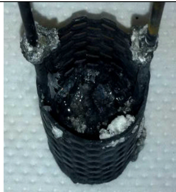
Interno del cestello: sono visibili lingotti di lantanio residuo e grumi di sale
