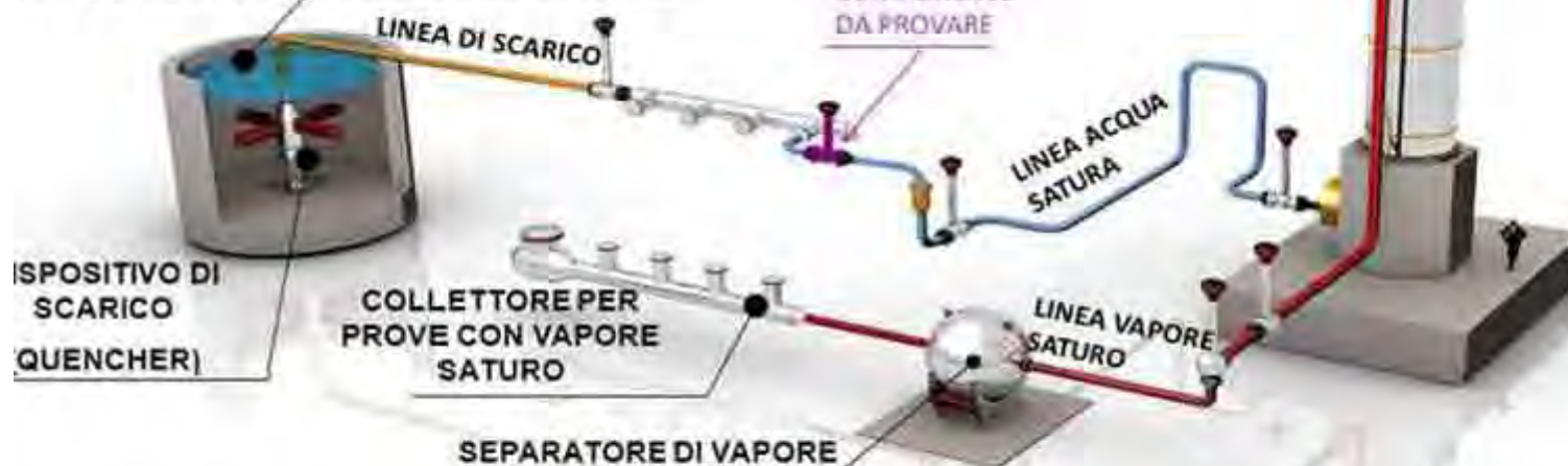
fig.5 : Sketch indicativo delle modalità d'installazione di un generico componente da provare con flusso di liquido
