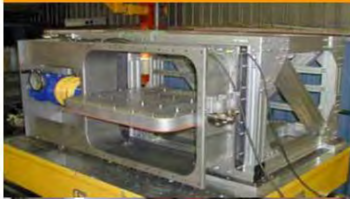
Figura 15: Saracinesche per la circolazione dei gas verso la riserva di acqua (vedi Figura 17). Normalmente aperte
