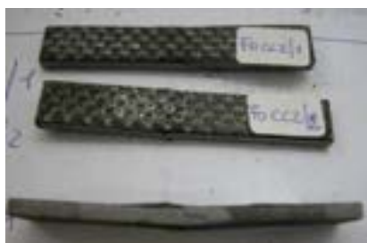
Fig. 10 – Provini dopo prova di flessione a tre punti
