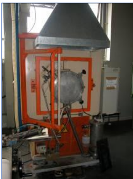
Fig. 66 – Forno ITEM per trattamenti di PIP
