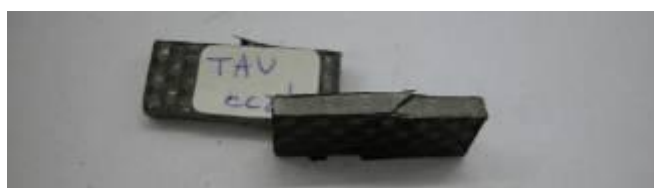
Fig. 13 – Immagine di provini dopo la prova di taglio interlaminare
