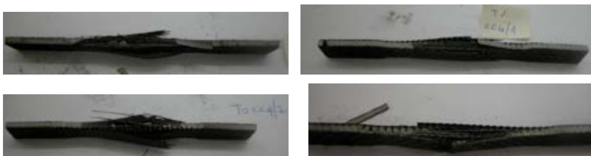
Fig. 8 – Prova di trazione – stato dei alcuni provini al termine della prova
