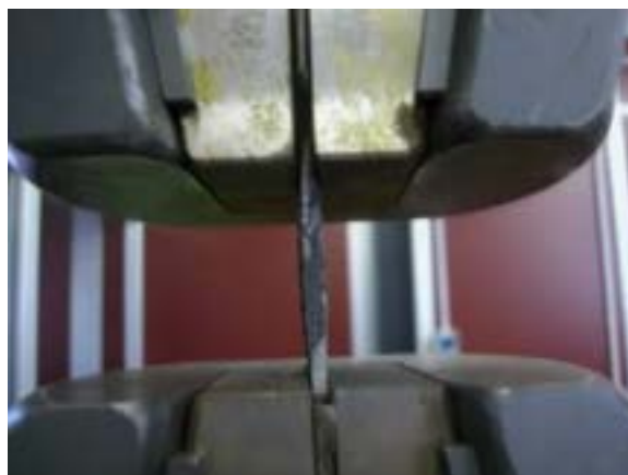
Fig. 7 – Stato del provino alla fine: rigonfiamento nella parte del tratto utile
