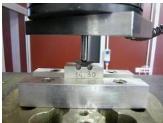
Fig. 12 – Prova di taglio interlaminare: distanza degli appoggi: 14.30 mm
