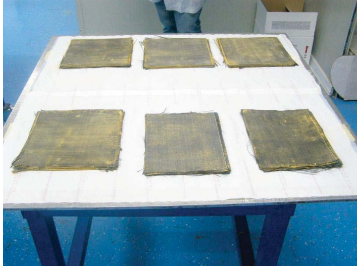
Fig1. Controllo e verifica dell'impilamento delle tele.
