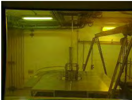
Fig. 4: Piattaforma d'acciaio posta in corrispondenza della piscina e dettaglio di un arco portadosimetri.
