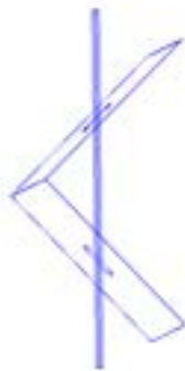
Figura 6 – Pale regolate a 45° rispetto all'asse di rotazione. Apertura minima 90°.
