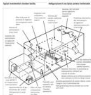
Figura 1 – Rappresentazione schematica di una camera riverberante con l'indicazione di diversi agitatori/sintonizzatori meccanici installati in diverse posizioni
