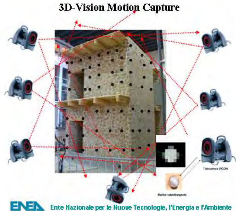
Figure 14 – Schema sistema 3D vision: posizione delle telecamere 5
