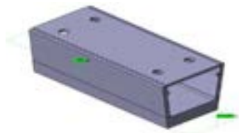
Mock-up per qualificare la procedura di saldatura sulla cassa (per le bobine per JT-60SA)
