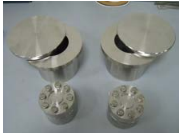
Fig. 11 Fase di chiusura delle sez. di prova
