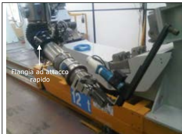
Fig. 5 Braccio esistente con flangia per sostituzione terminale
