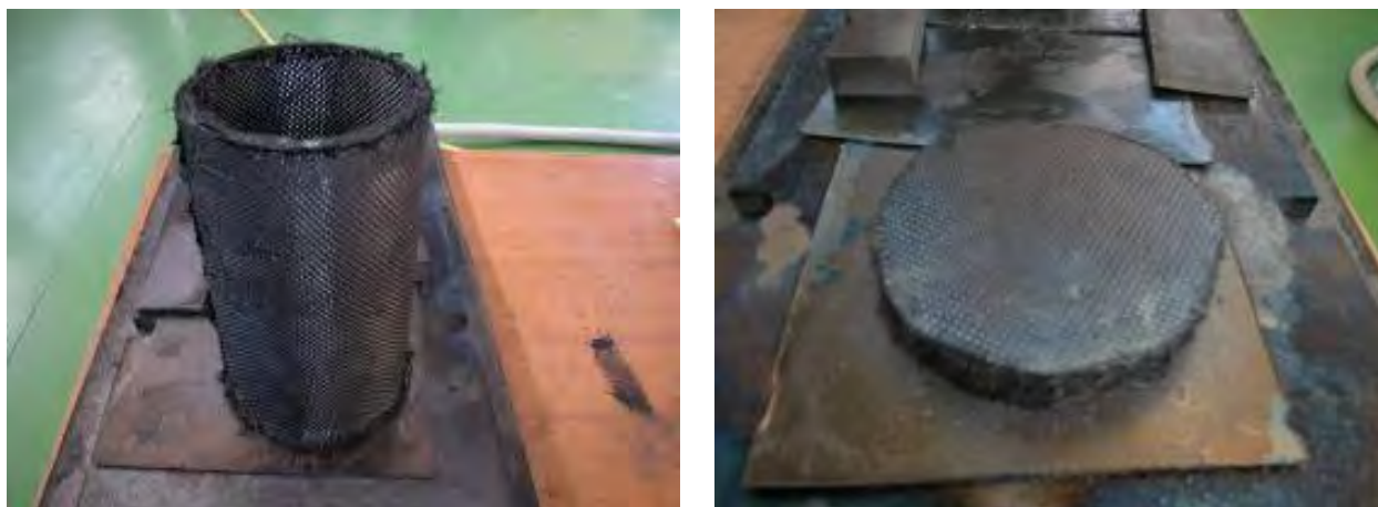
Figura 19 – Preforme del tubo e del fondo (dopo rifilatura)
