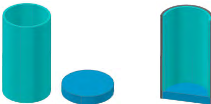
Figura 20 – Schema di assemblaggio del crogiolo
