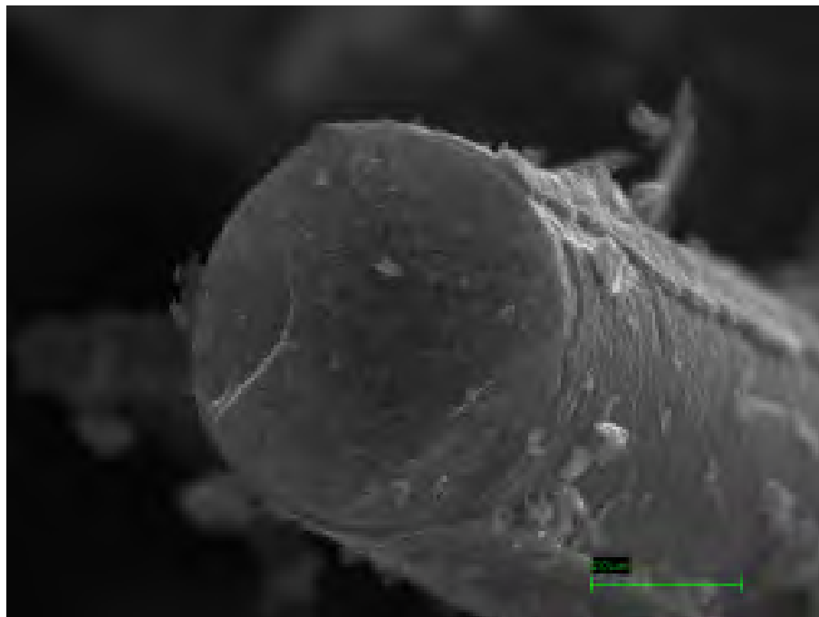
Figura 10 - Immagine a 25000 X che evidenzia la ricopertura delle fibre di SiC con l'interfase di C
