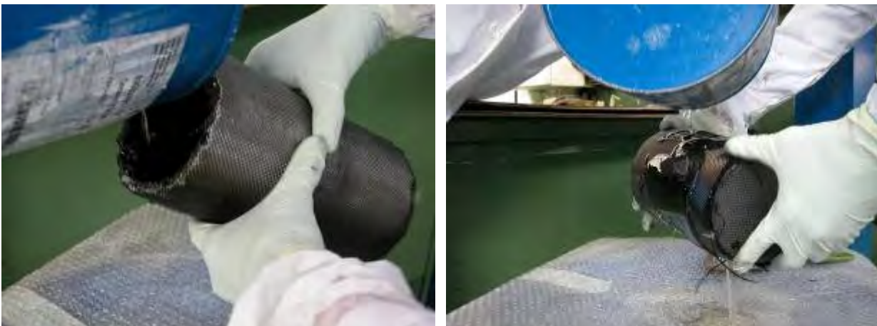
Figura 21 – Impregnazione del crogiolo prima del trattamento termico
