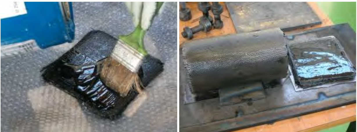
Figura 21 – Impregnazione del crogiolo prima del trattamento termico
