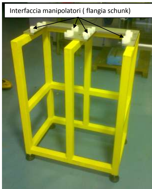
Fig. 5 Struttura di supporto manipolatori
