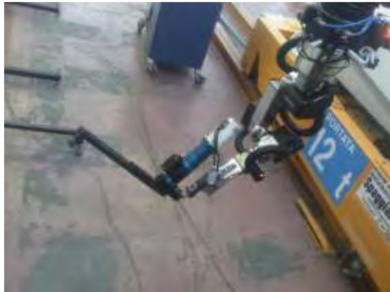
Fig. 2 Manipolatore con dispositivo di avvitamento.
