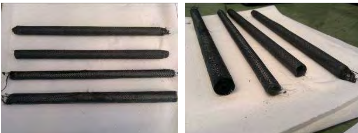
Figura 14 – Tubi dopo ciclo di cura della resina
