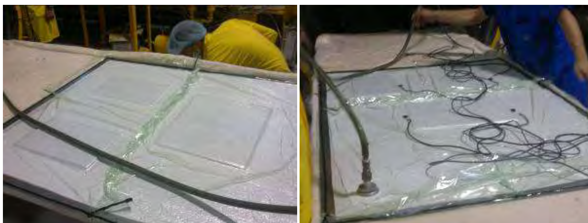
Figura 10 – Particolare fase vuoto e posizionamento termocoppie
