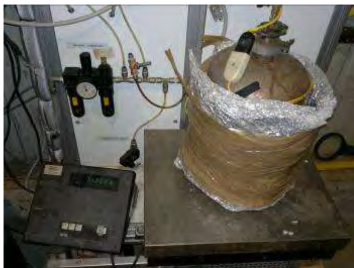
Figura 4 – Particolare impianto CVI – contenitore MTS
