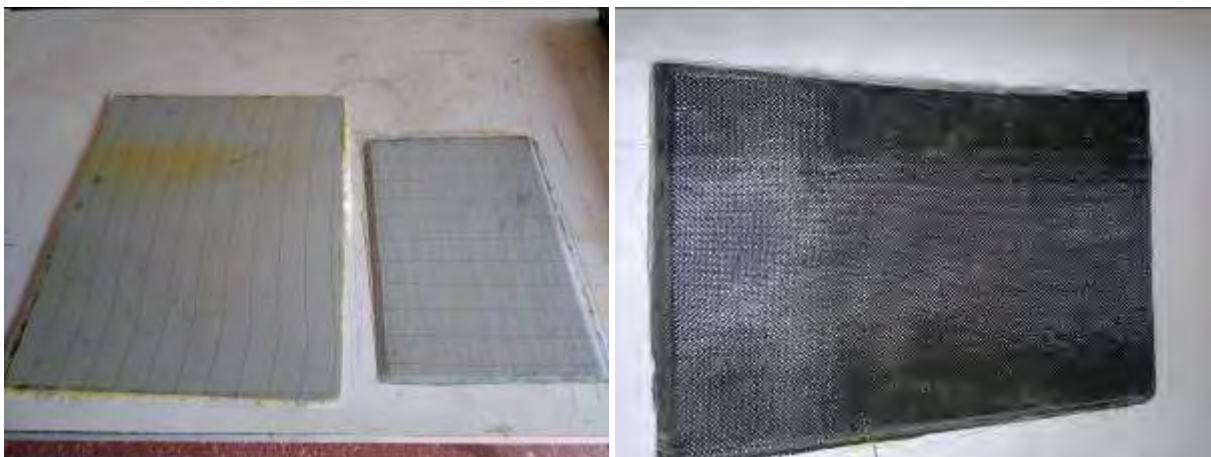
Figura 9- Preforme prima e dopo ciclo di pirolisi ad alta T
