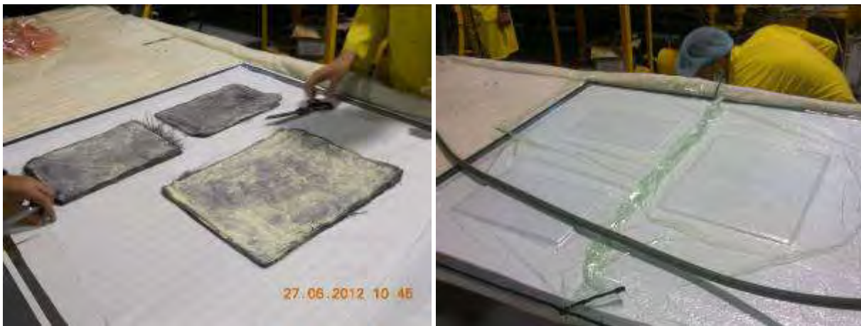
Figura 8 – Posizionamento preforme e sacco vuoto
