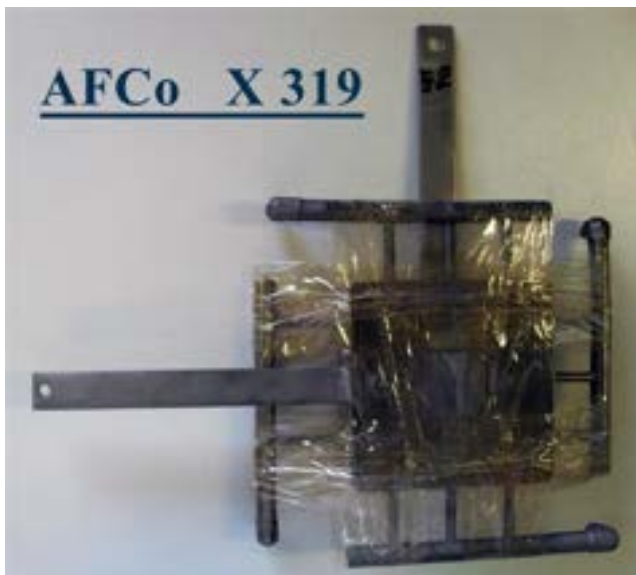
Figura 2. Cella mcfc AFCo X 319 prima dell'installazione.
