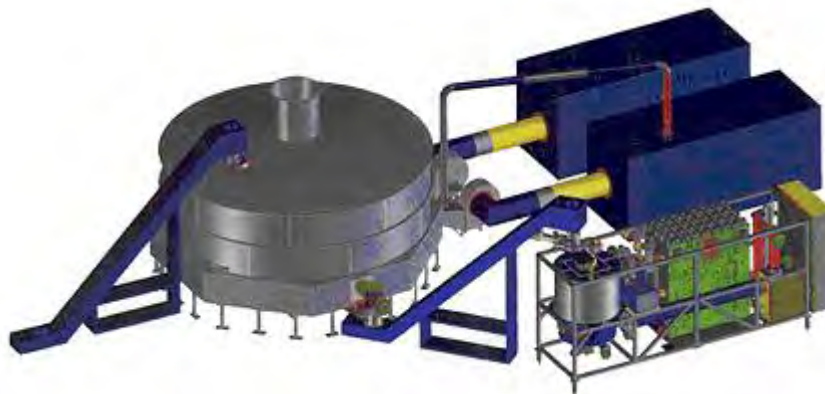
Schema Layout 3D relativo ad un impianto di gassificazione
