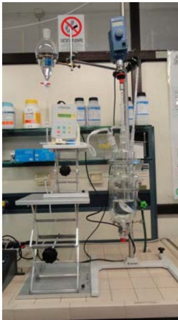
Fig.6: Reattore CSTR, micro pompa per la fase di miscelamento e di cristallizzazione
