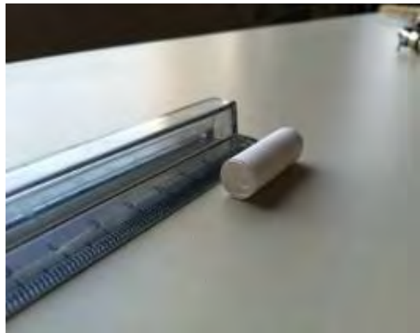
Figura 51. Supporti ceramici sinterizzati in figura il campione di zirconia
