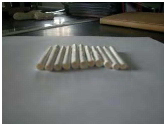
Figura 62- campioni sinterizzati prima del taglio
