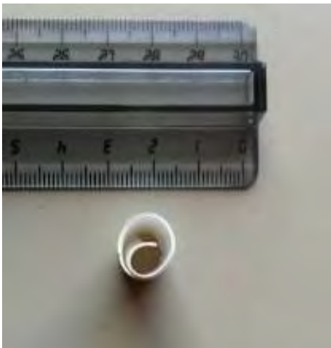
Figura 51. Supporti ceramici sinterizzati in figura il campione di zirconia
