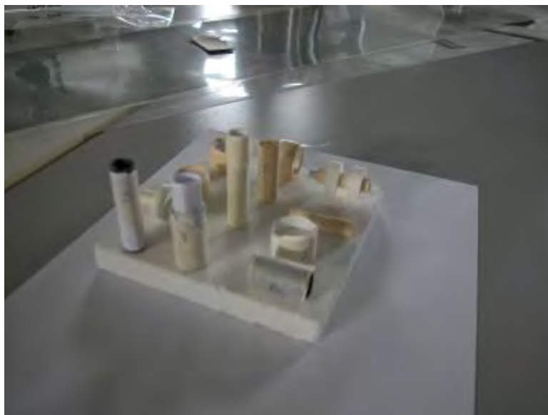
Figura 55- Campioni allo stato di verde
