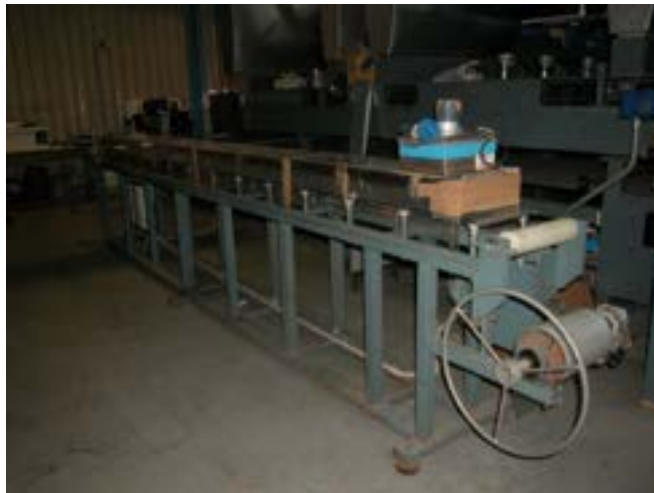
Figura 49 - Tape casting di laboratorio
