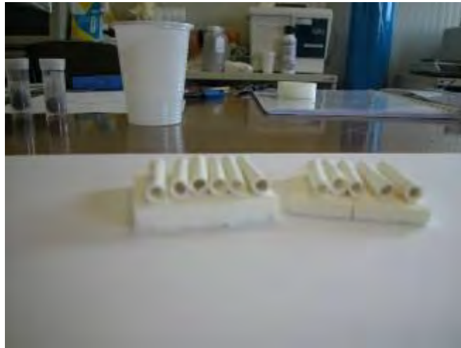
Figura 63- Campioni dopo la prova di taglio
