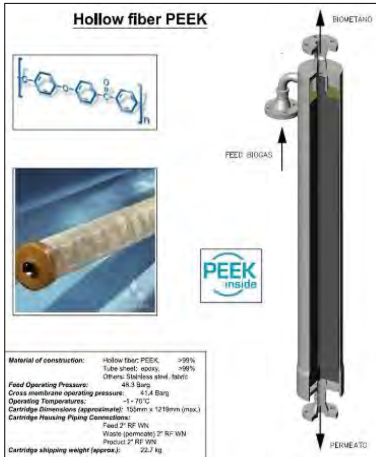
Figura 5 - Caratteristiche principali del modulo a membrane polimeriche PEEK
