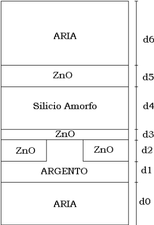
Figura 16 - Struttura della cella con lo strato di ZnO tra la nanogriglia e il layer attivo
