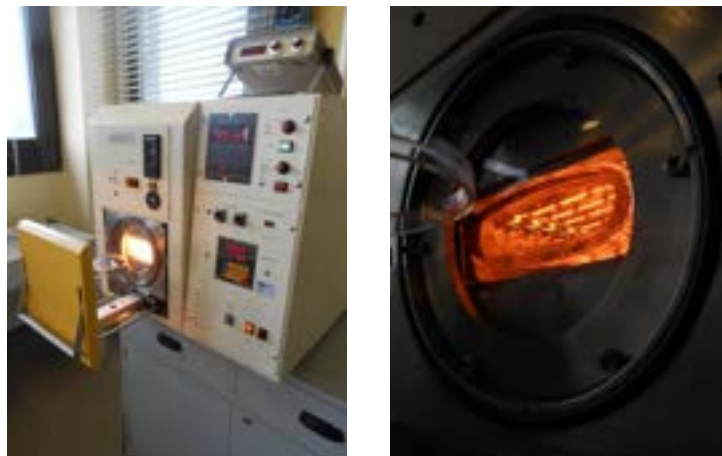
Figura 19. Immagini del forno RTP e un dettaglio delle lampade all'esterno della camera di quarzo.
