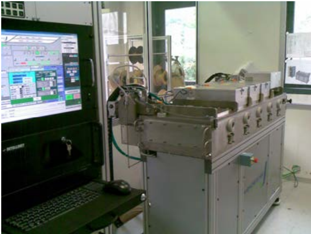
Figura 27. Impianto di sputtering per la deposizione di film sottili di Mo , ZnO e ZnO:Al
