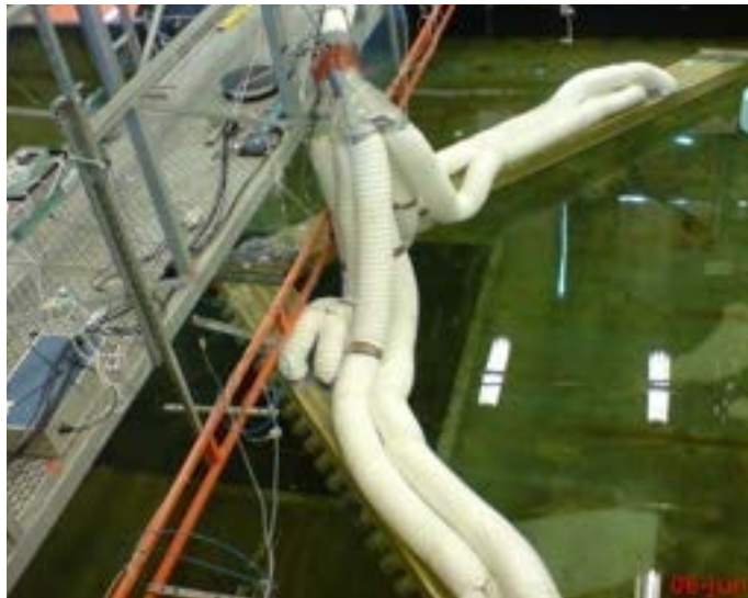
Figura 7.17 - Tubi bianchi flessibili che convogliano il flusso d'aria ad un punto centrale.
