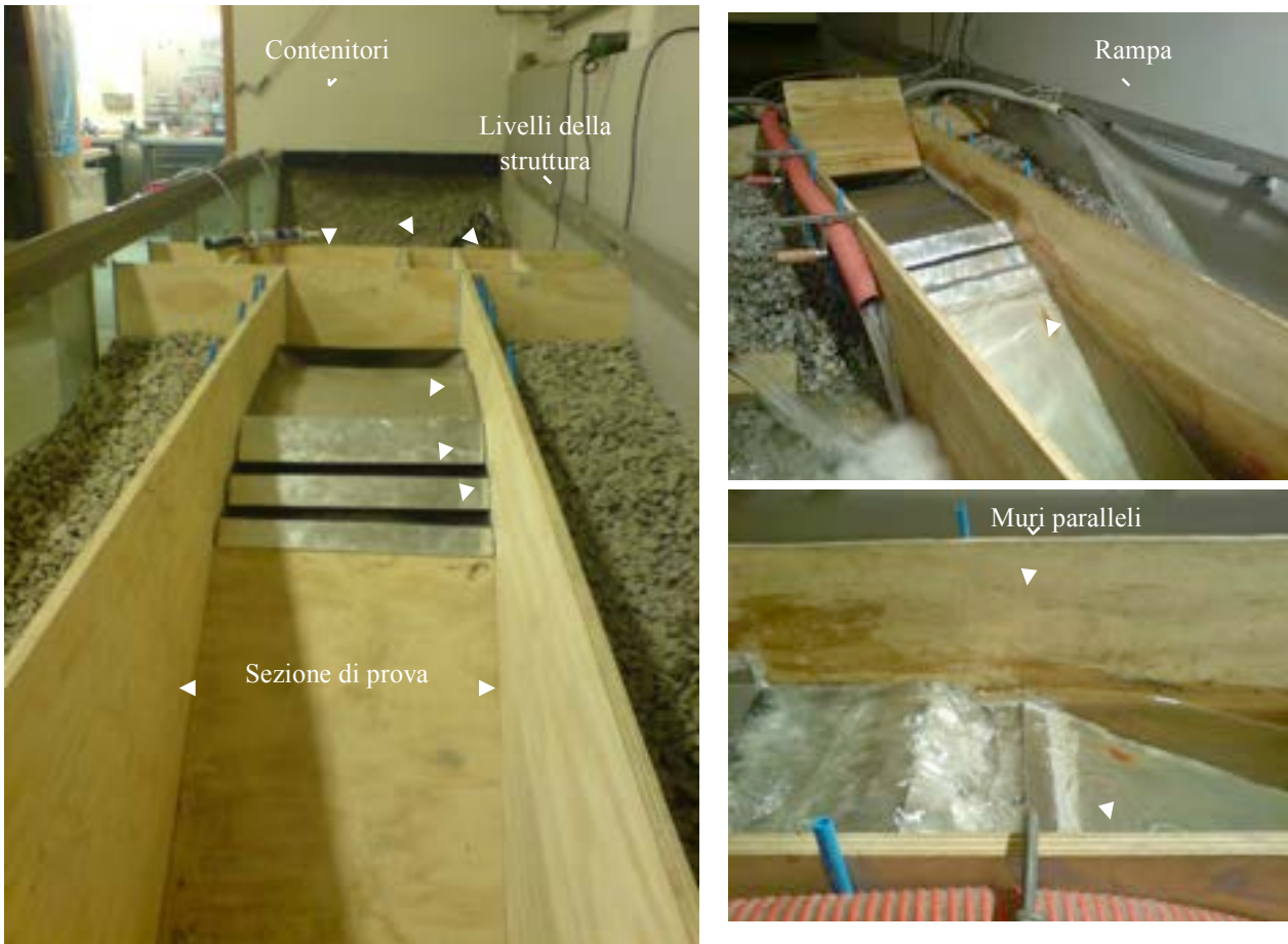
Figura 7.22 - A sinistra: Sistemazione in canale del modello SSG. A destra, in alto: Modello SSG in azione; in basso: Ingrandimento del modello durante la fase di tracimazione e raccolta dell'acqua nei serbatoi.
