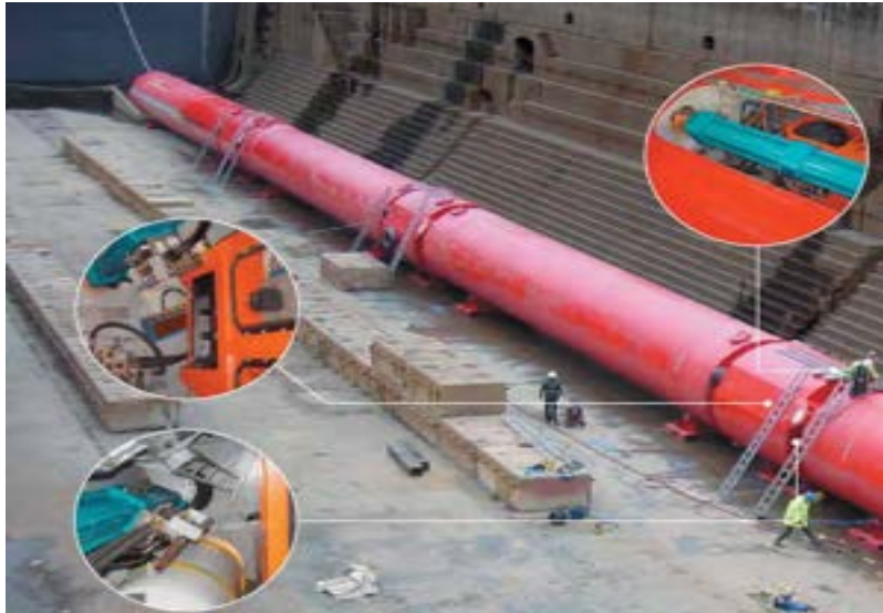
Figura 4.1 - Dettagli dei moduli di conversione dell'energia del Pelamis.
