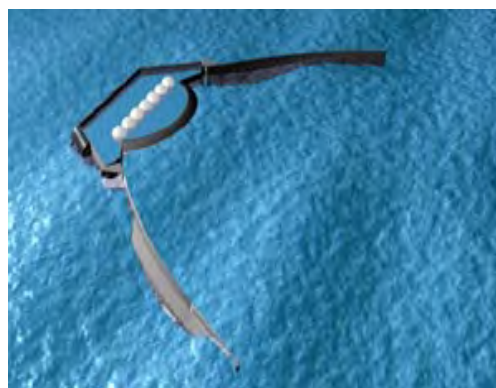
Figura 2.5 - Schema del dispositivo a tracimazione offshore Wave Dragon (sito web http://www.wavedragon.net ).
