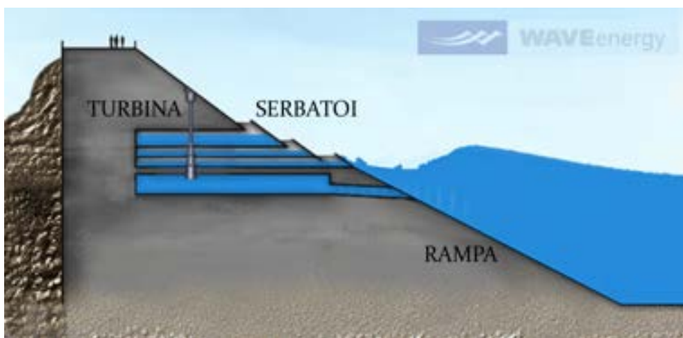
Figura 7.21 - Schema del sistema Seawave Slot-Cone Generator (SSG).
