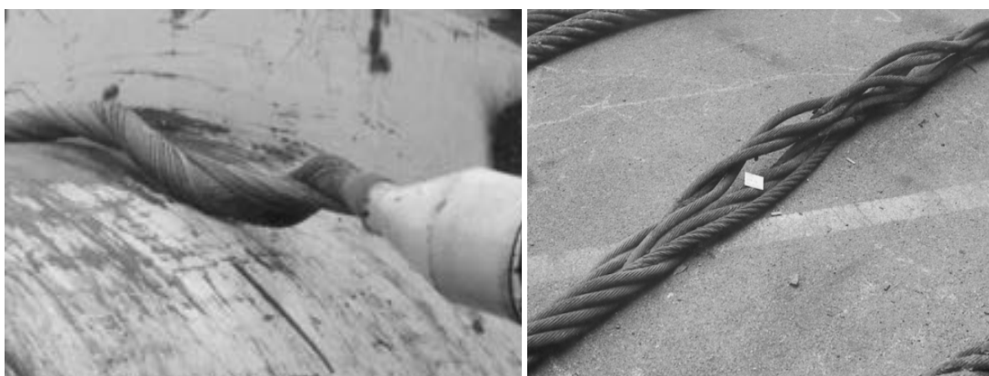
Figura 6.5 – Tipiche modalità di rottura (Chaplin 1998). A sinistra: danno in un filo a spirale a causa dell'elevata torsione di carico. A destra: Danno di sfilamento in un trefolo a sei cavi.
