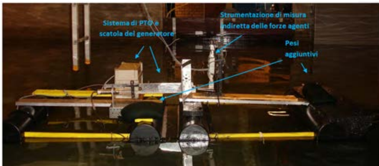
Figura 7.5 - Modello in scala 1:20 del dispositivo, utilizzato per lo studio sperimentale.
