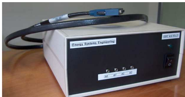
Figura 8 Box di interfaccia per la trasduzione ottica-elettrica
