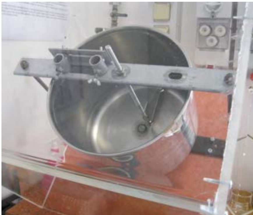
Figura 101. Fotografia del reattore di carbonatazione-granulazione realizzato.
