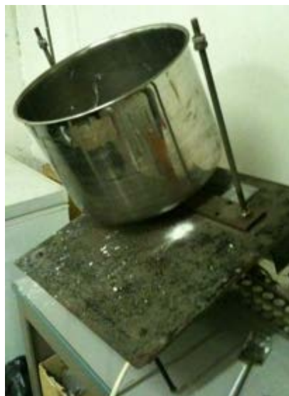
Figura 54. Corpo cilindrico centrale del reattore di granulazione.
