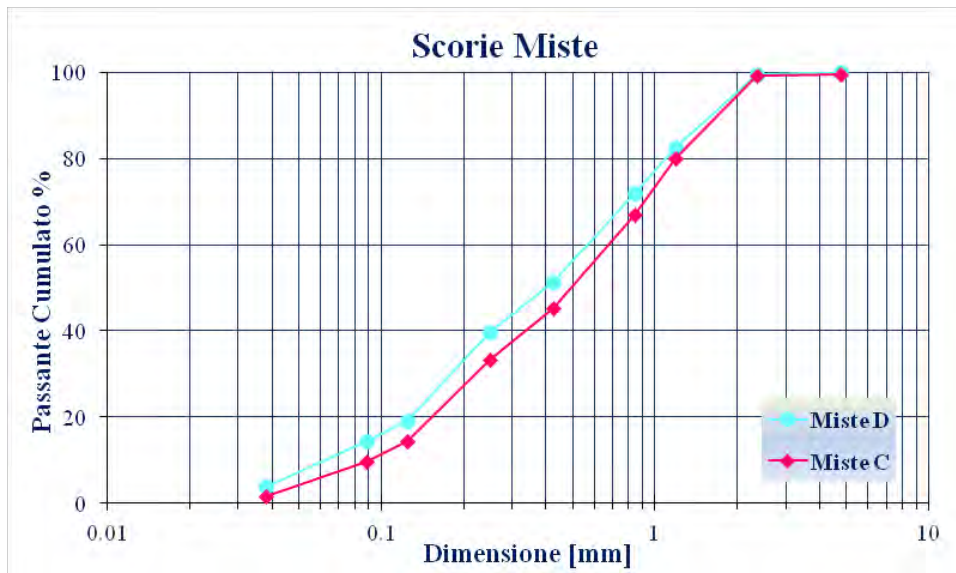
Figura 2. Distribuzione granulometrica della miscela di scorie miste analizzate.
