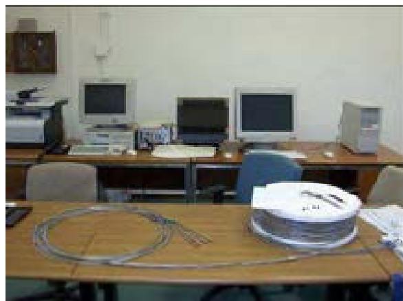
Figura 4: Fibra ottica in quarzo per remotizzare il segnale delle sonde
