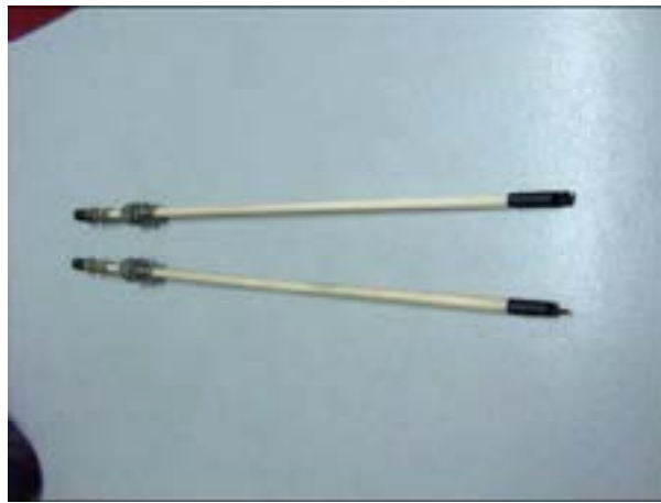
Figura 3: Sonda ODC per alta temperatura in zaffiro
