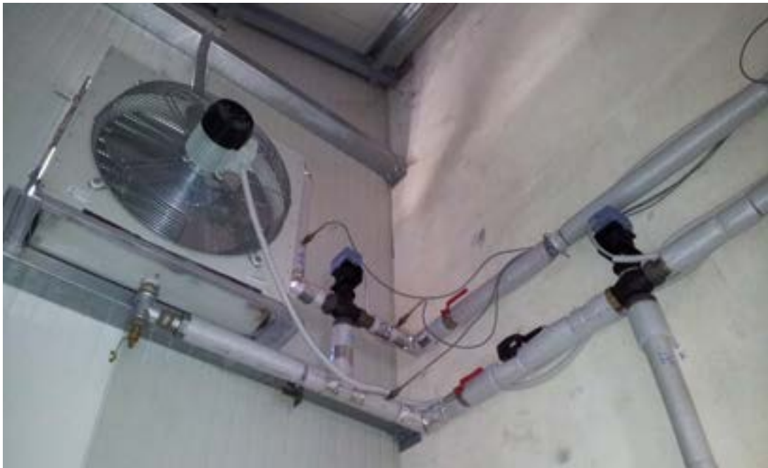
Fig. 40: sistema di simulazione del carico termico
